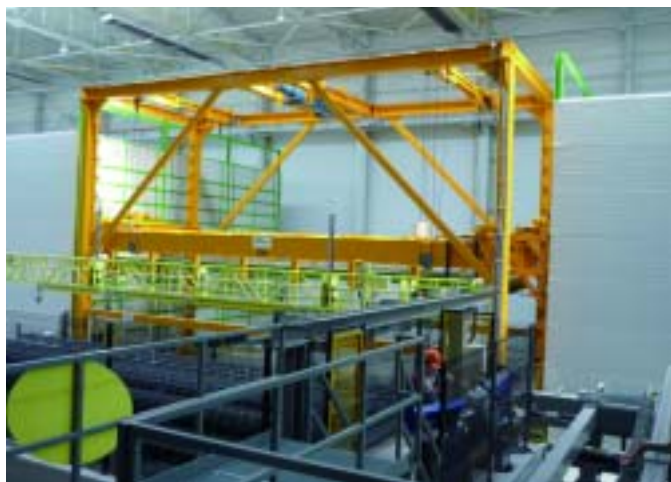
Устройство, обслуживающее полки, и сушильная камера
