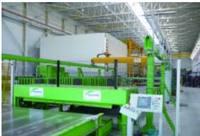
Устройство очистки поддонов
