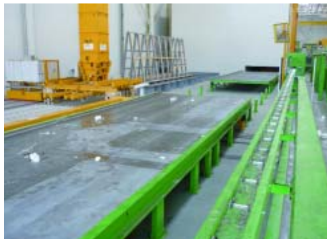
Распалубочная станция, зажим и ленточный транспортер
