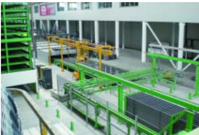
Пост ручной опалубки
